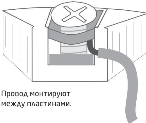
Провод монтируют между пластинами.
